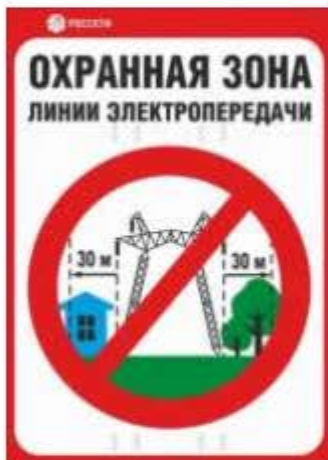
Рис.9 ЗБ «Охранная зона ЛЭП - 500 кВ – 30 м»
