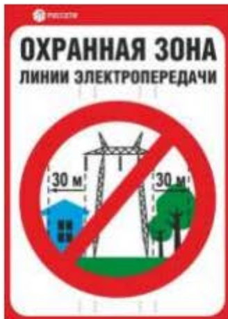
Рис.8 ЗБ «Охранная зона ЛЭП - 330 кВ – 30 м»
