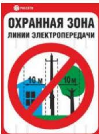
Рис.4 ЗБ «Охранная зона ЛЭП - 10 м».
